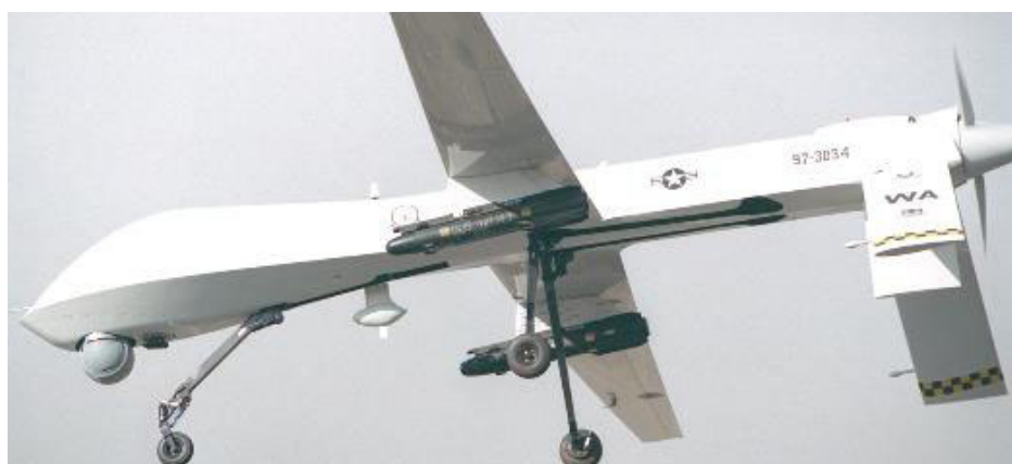
БПЛА RQ-1 Predator, вооруженный ракетами Maverick
