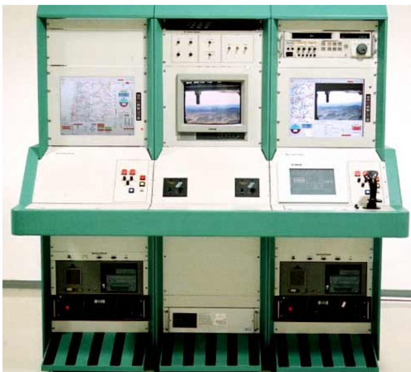
Рабочее место оператора пункта управления и контроля
