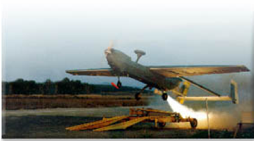
Старт БПЛА RQ-5A Hunter с помощью РДТТ
