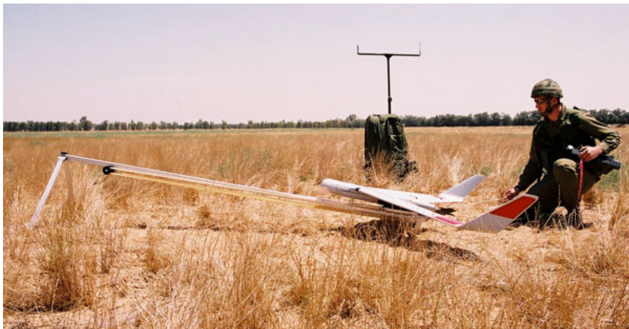
БПЛА Orbiter на стартовой катапульте
