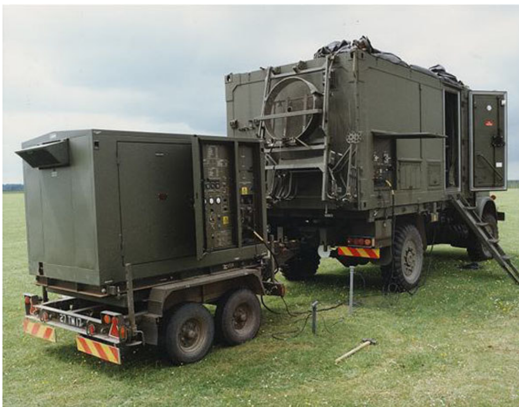
Пункт управления БПЛА Phoenix с прицепом агрегатов электропитания
