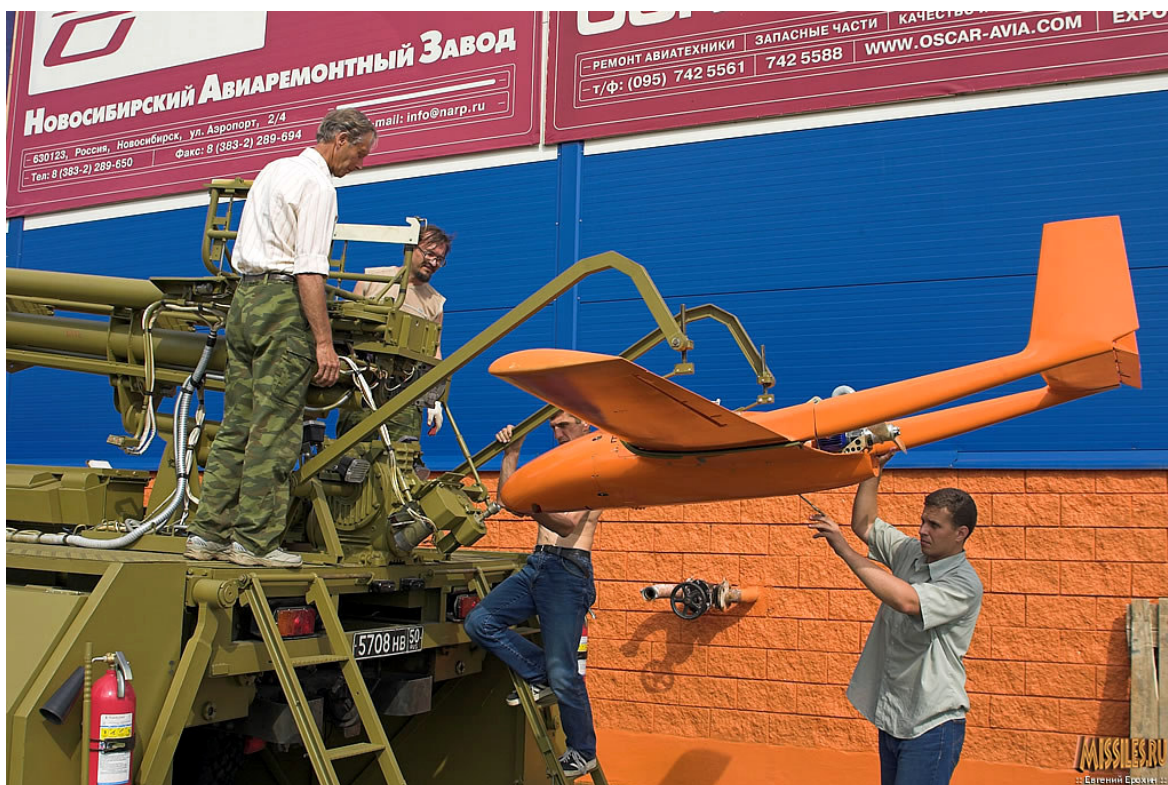
Погрузка БПЛА 9М62 «Типчак» на стартовую установку
