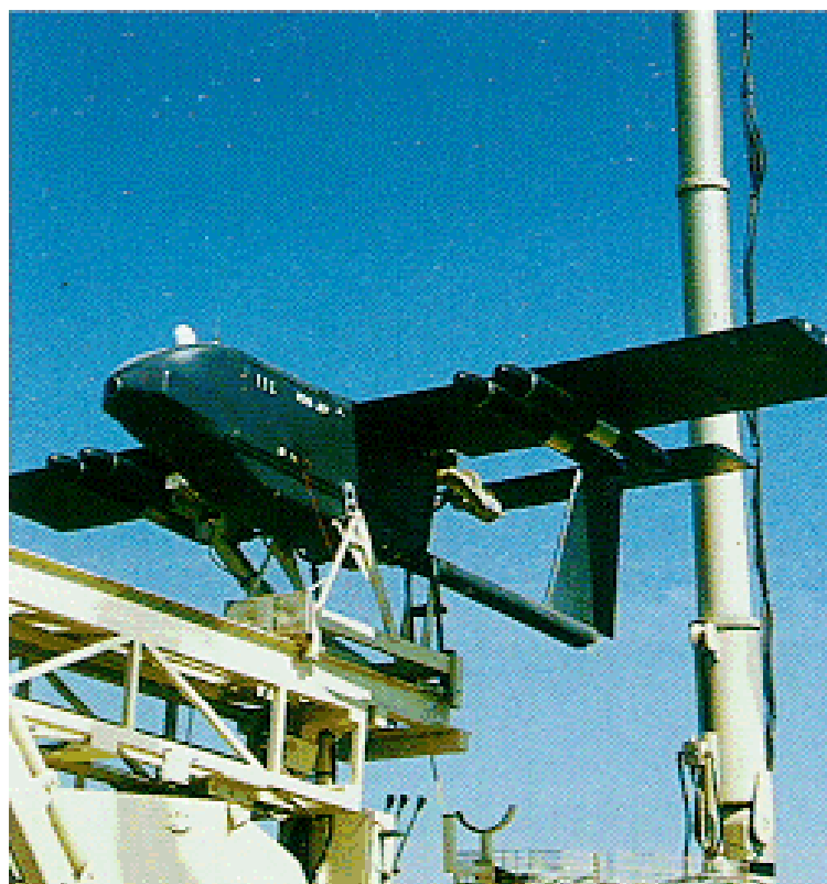
БПЛА Fox AT1 на разгонной установке
