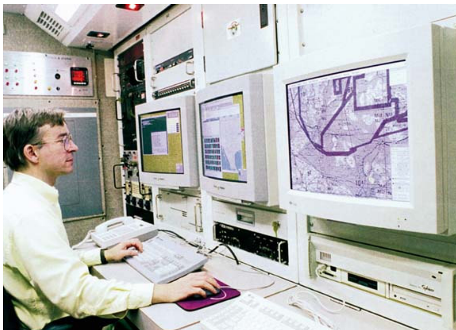
Рабочее место оператора управления БПЛА RQ-3A Dark Star
