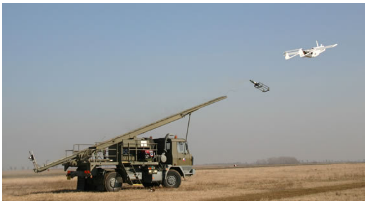
Взлет БПЛА Sojka III (отделение ракетного ускорителя)
