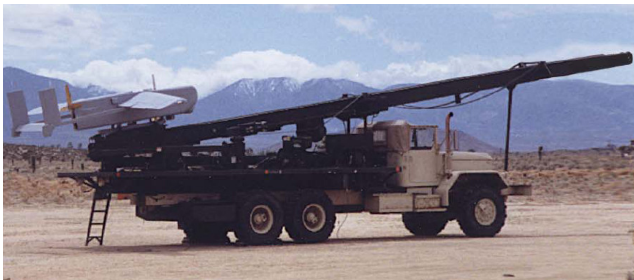
БПЛА SkyEye на стартовой катапультной установке на базе автомобиля
