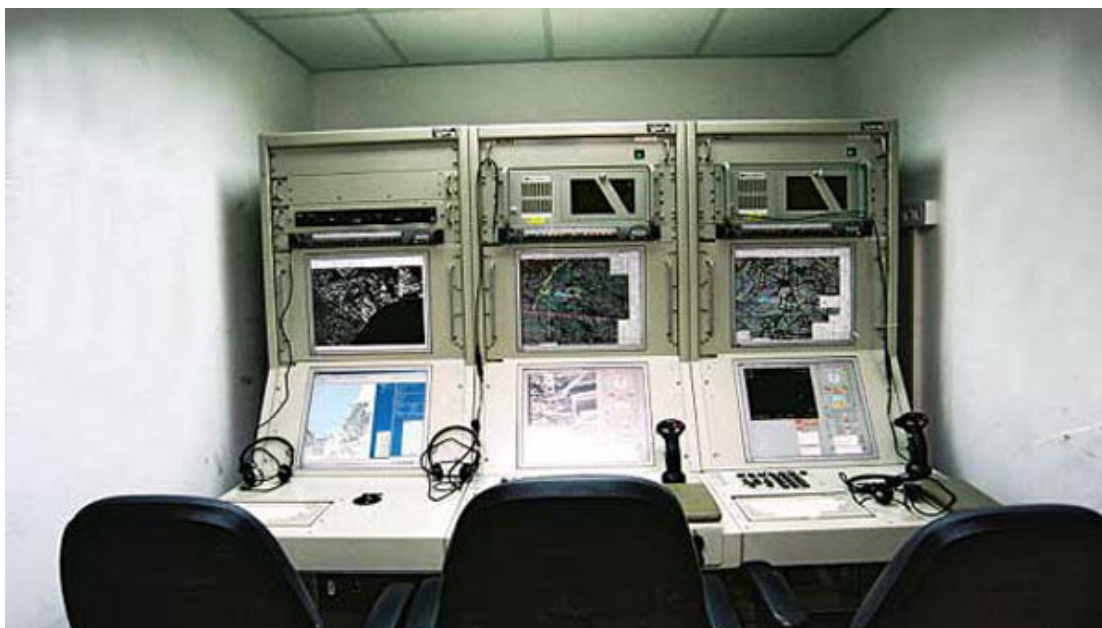
Наземная станция управления БПЛА Heron
