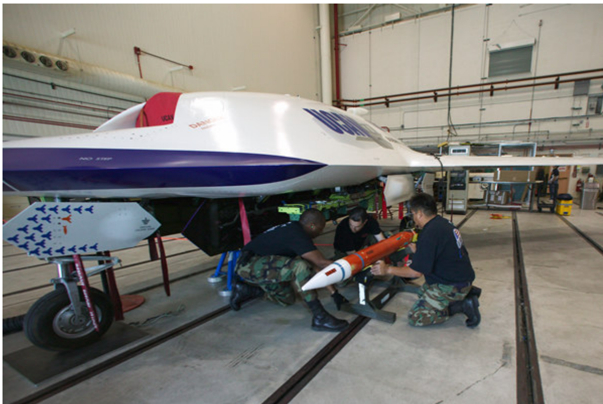
Подвеска вооружения БПЛА X-45A
