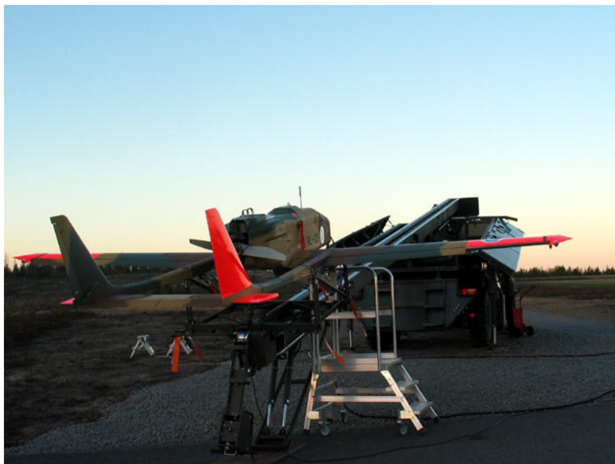
БПЛА ADS 95 Ranger на стартовой установке
