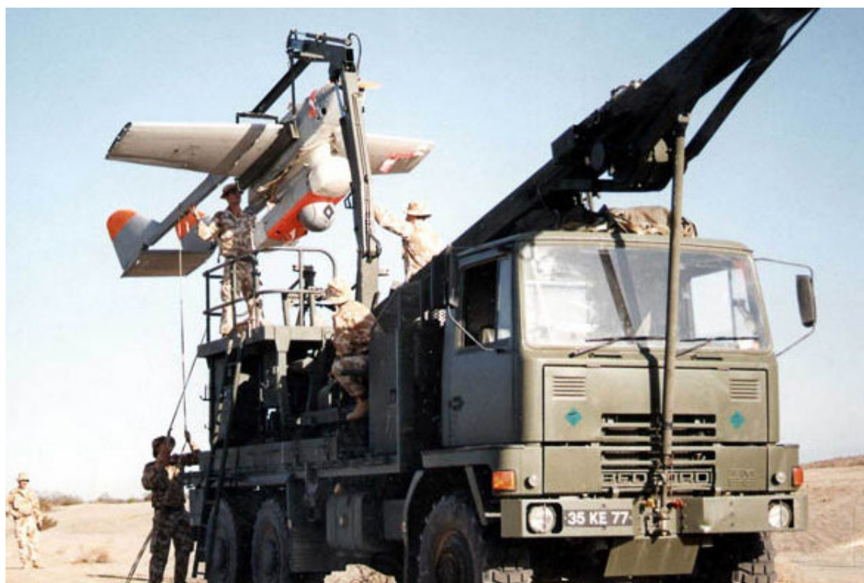
Установка БПЛА Phoenix на катапультную установку
