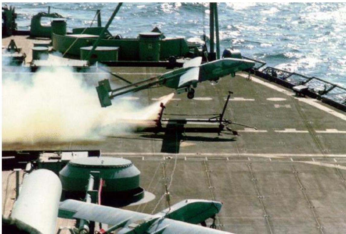
Старт БПЛА RQ-2 Pioneer с палубы корабля с помощью стартового ускорителя
