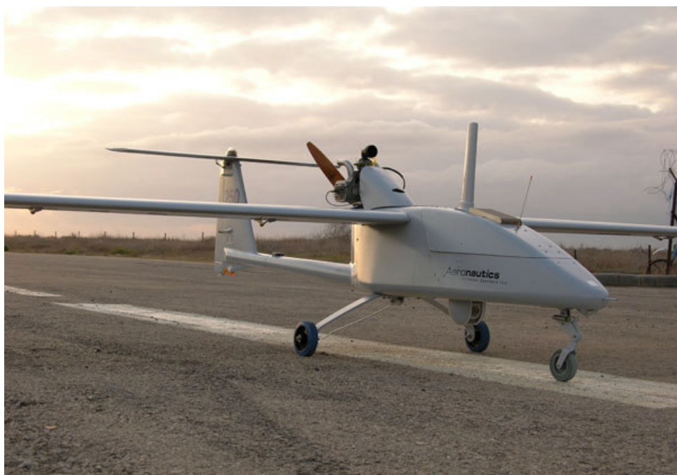
Размещение антенн на БПЛА Aerolight
