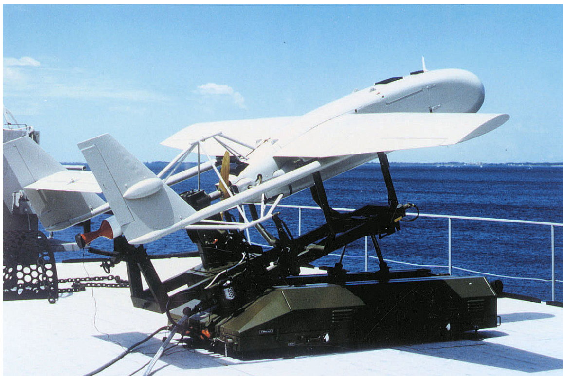
БПЛА Mirach 26 на стартовой установке
