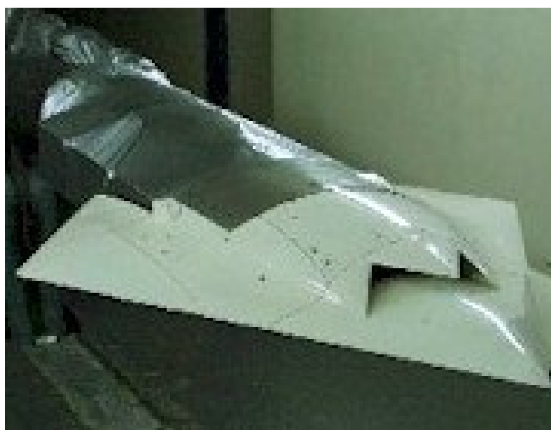
Модель БПЛА X-47A Pegasus в аэродинамической трубе
