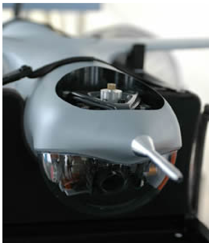
Отсек полезной нагрузки БПЛА ScanEagle
