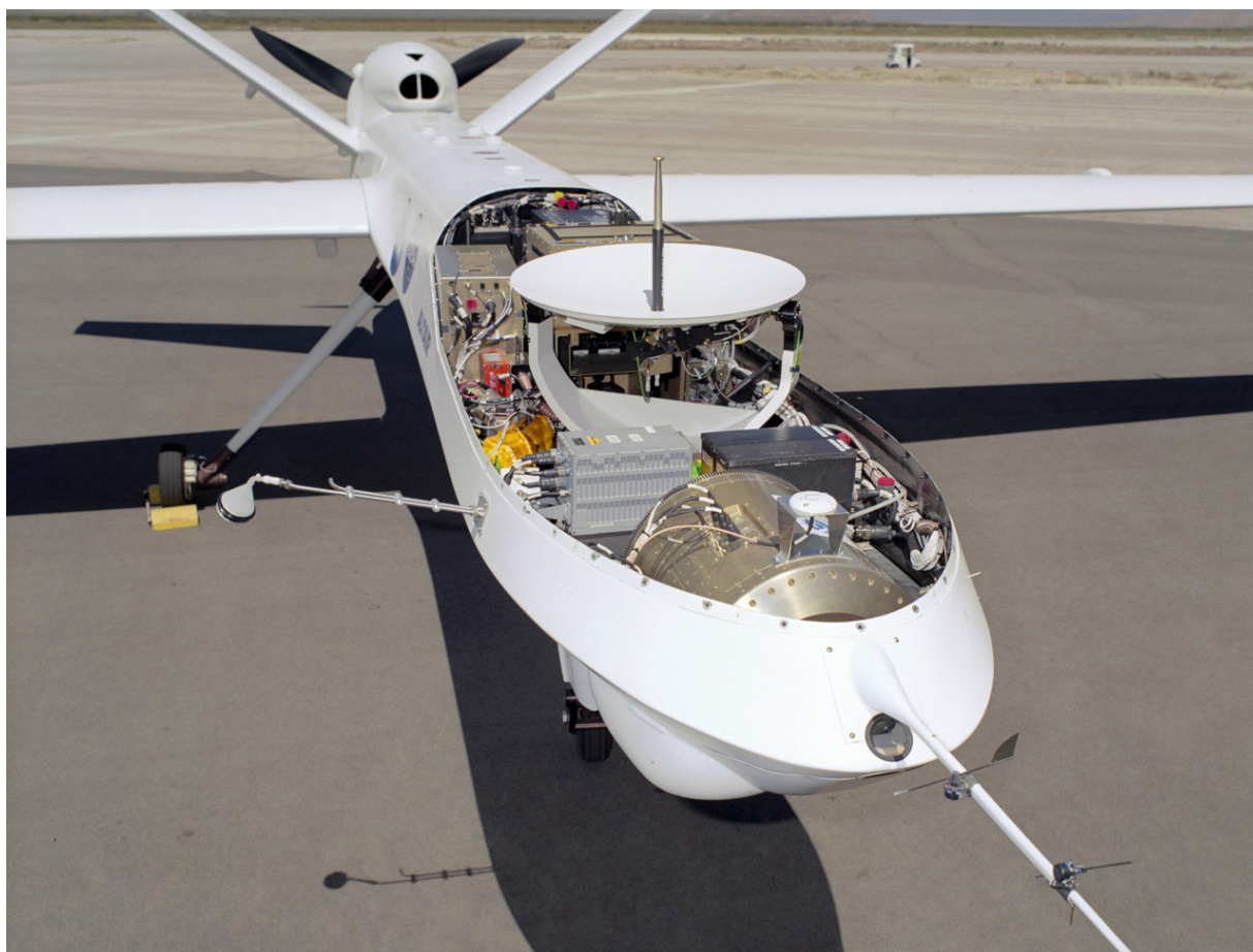
Отсек БРЭО БПЛА Altair
