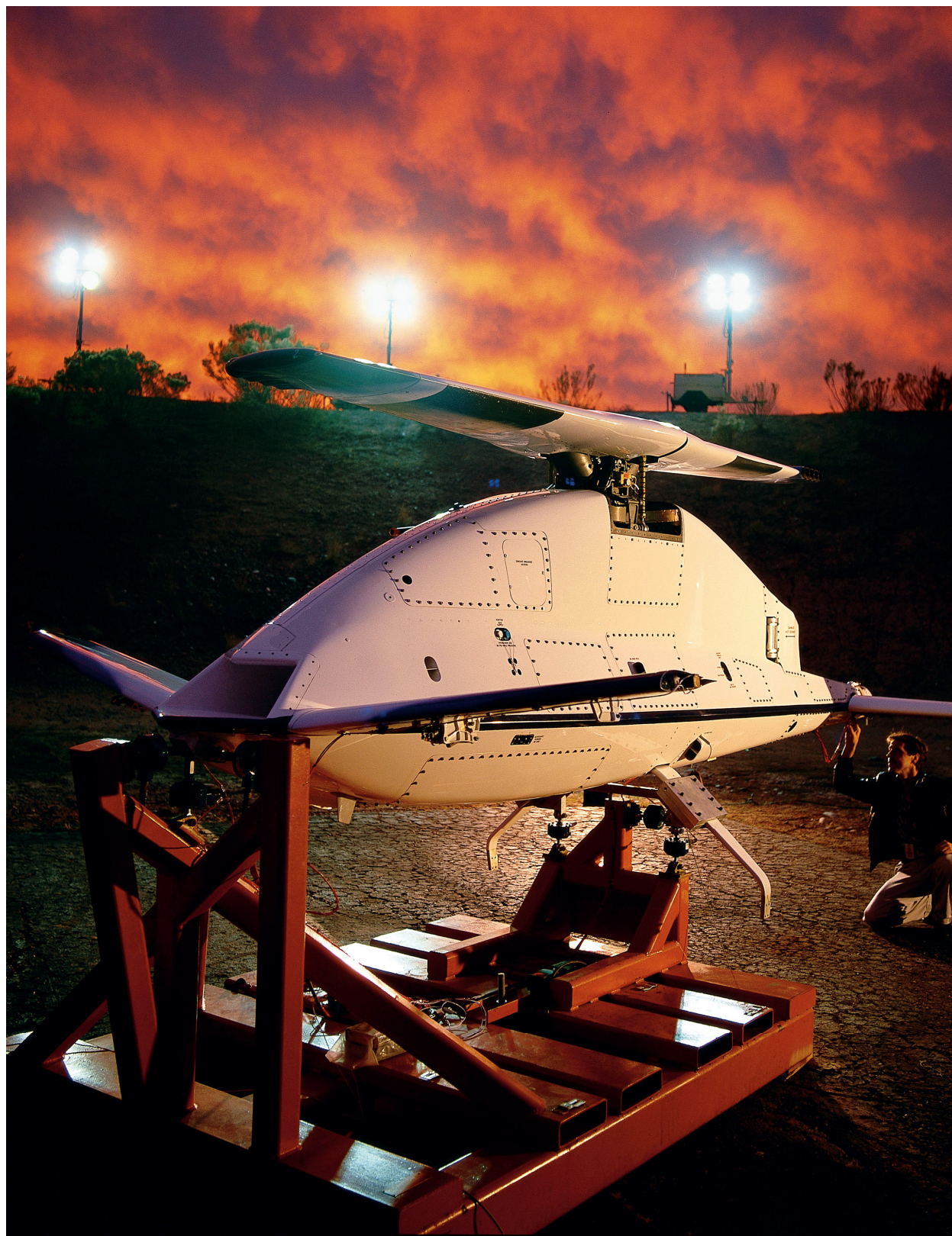
БПЛА X-50A Dragonfly на испытательном стенде для измерения сил и моментов
