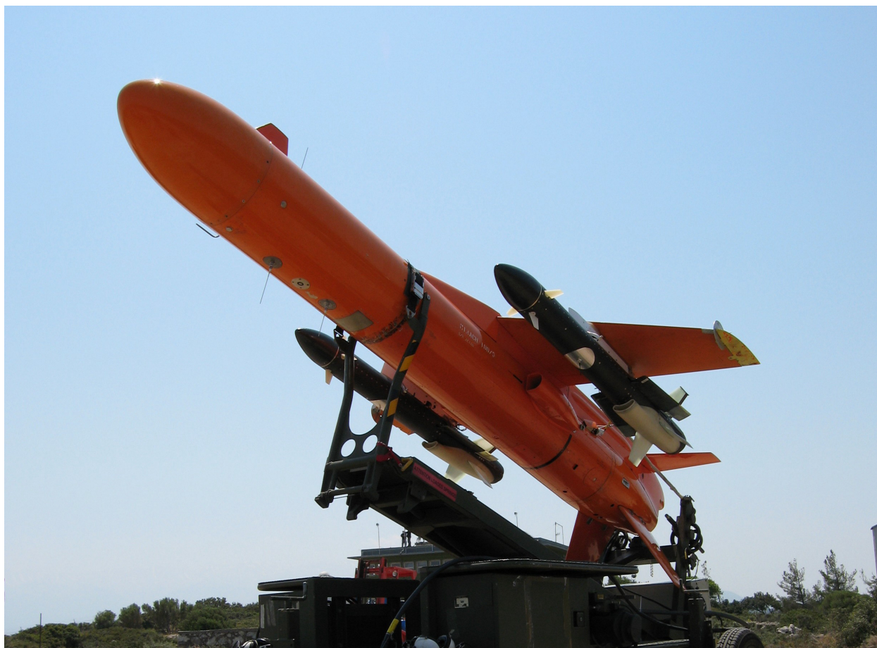
БПЛА Mirach 100/5 с дополнительными ложными целями
