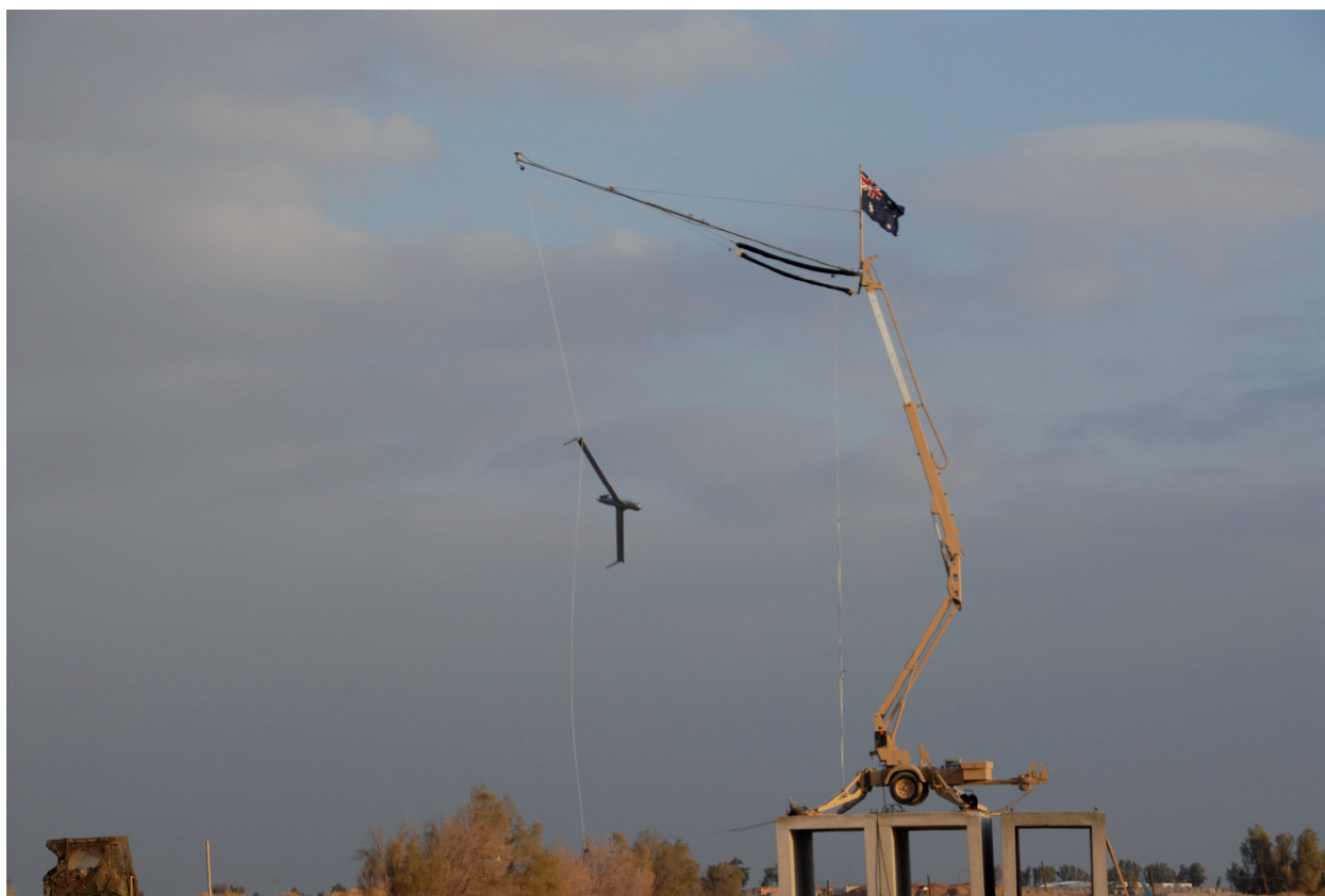
Посадка БПЛА ScanEagle с помощью системы Sky Hook (Ирак)
