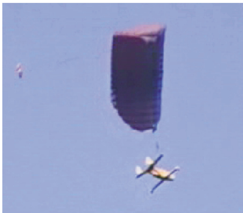
Полет БПЛА Поиск-2 под аэроупругим крылом
