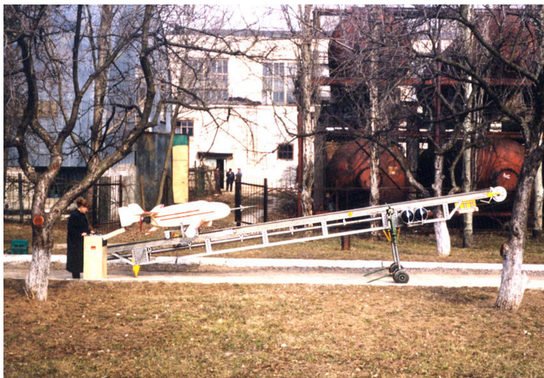
Катапультная установка для БПЛА Поиск-2
