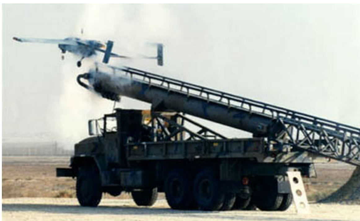
Старт БПЛА RQ-2 Pioneer с помощью катапульты
