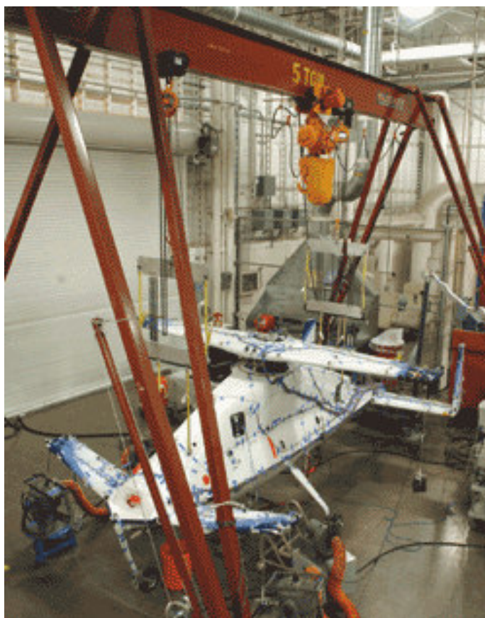
БПЛА X-50A Dragonfly в зале для статических испытаний
