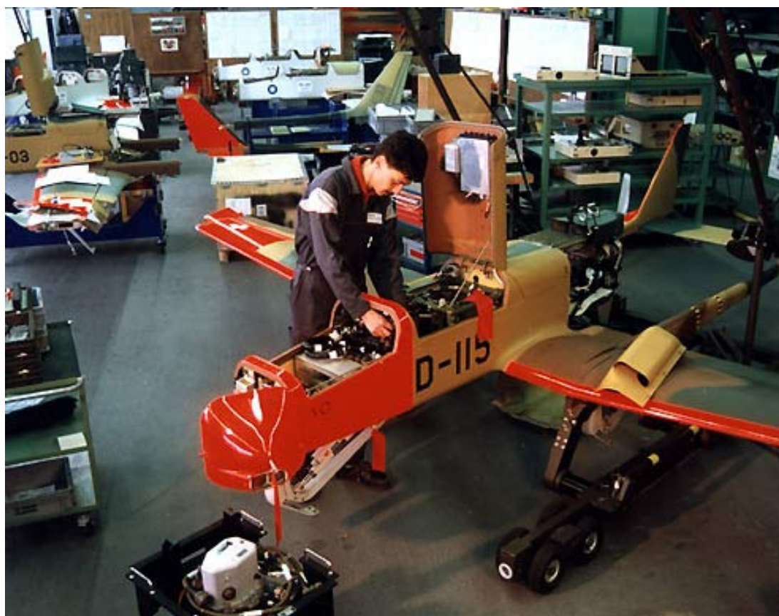
БПЛА ADS 95 Ranger на производственном участке
