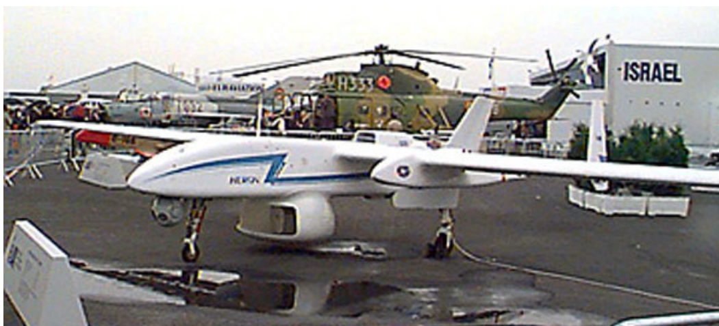
БПЛА Heron с РЛС Elta EL/M-2022U на Парижском авиасалоне
