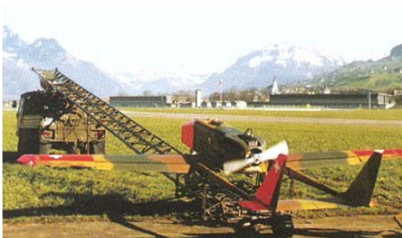
БПЛА ADS 95 Ranger на стартовой установке
