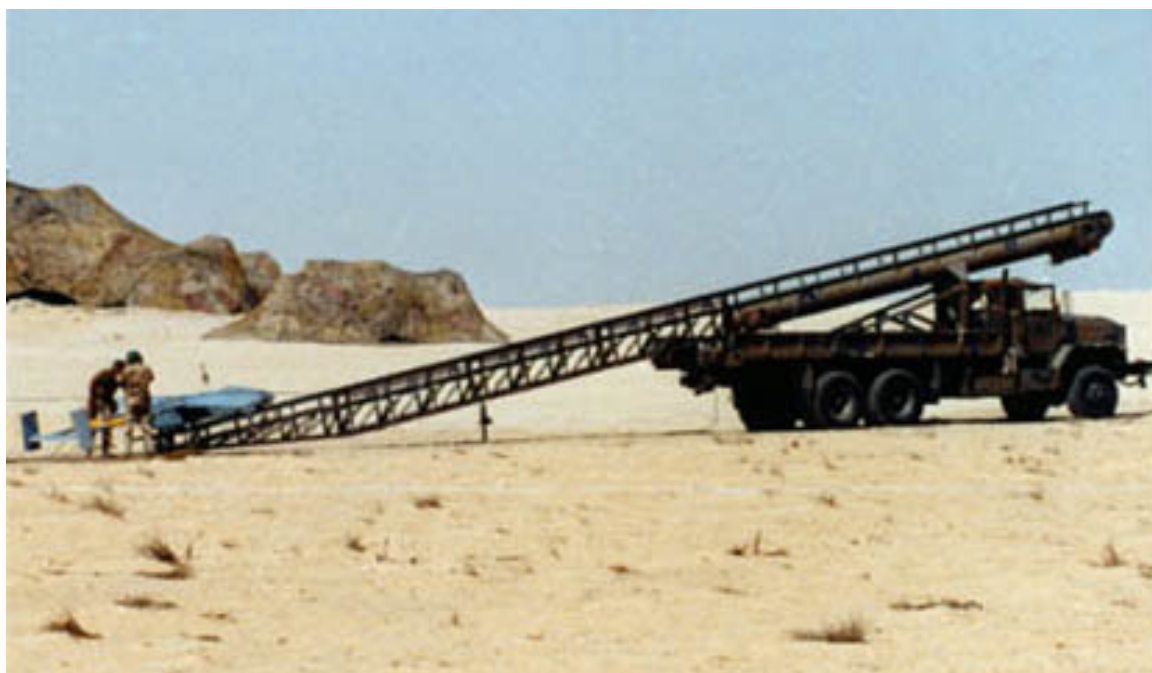
Старт БПЛА RQ-2 Pioneer с помощью катапульты
