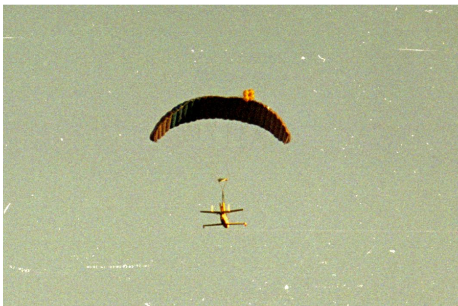
Посадка БПЛА Поиск-2 на аэроупругом крыле
