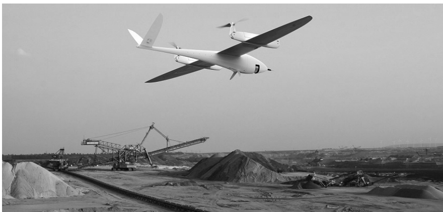
Рисунок 20 – Конвертоплан Tron F90+ [20], предназначенный для нужд сельского хозяйства и геологических исследований
