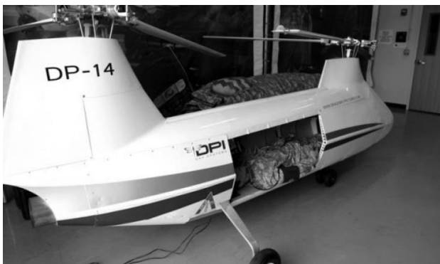
Рисунок 6 – Санитарный БВС тандемной вертолетной схемы DP-14 DPI [6]
