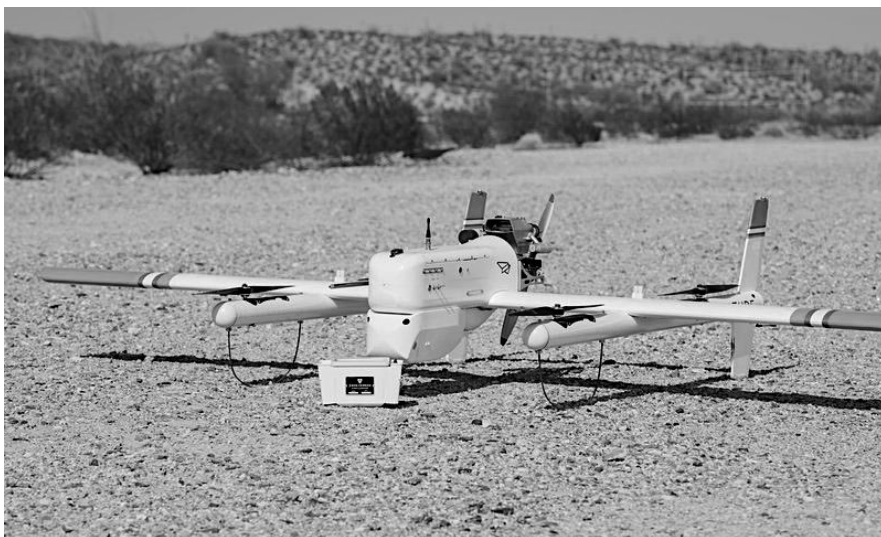
Рисунок 19 – Крылатый мультикоптер HQ-40 [19], предназначенный для экстренной доставки биологических образцов
