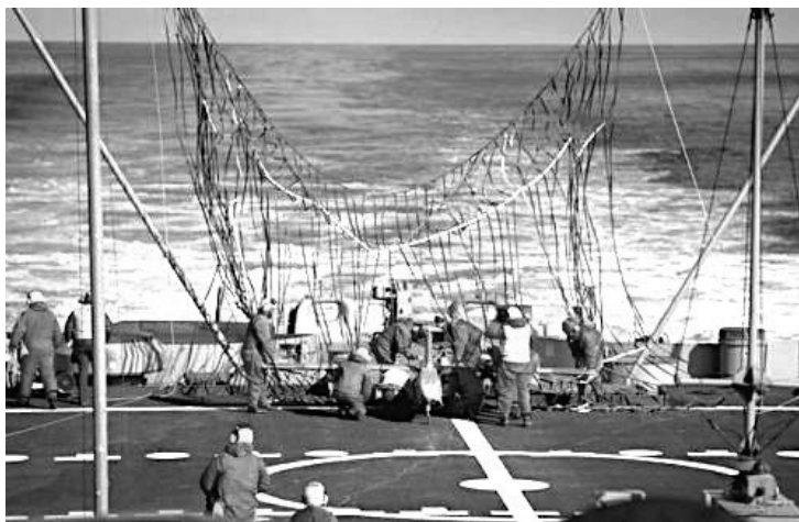
Рисунок 2 – Посадка БВС RQ-2 Pioneer [2] в сеть-уловитель на палубе
