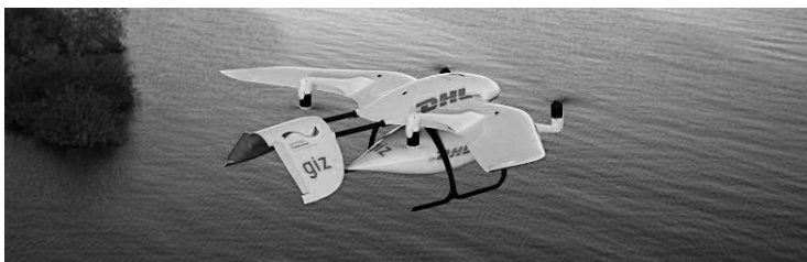
Рисунок 16 – Крылатый мультикоптер Wingcopter DHL Parcelcopter 4.0 [16]
