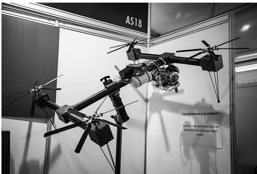
Рисунок 29 – Мультикоптер Belias с изменяемым шагом винта компании SOAPdrones [31]
