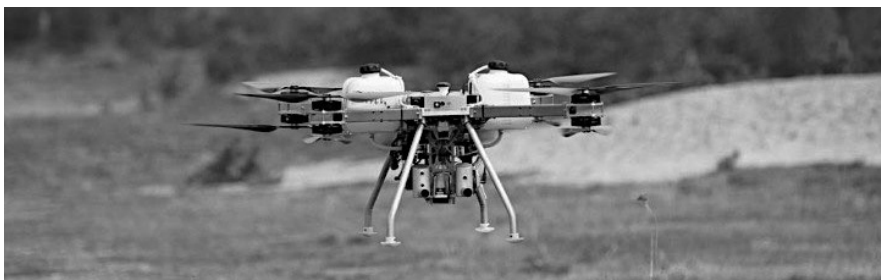
Рисунок 28 – Мультикоптер с гибридной силовой установкой Airborg H8 10K [30]
