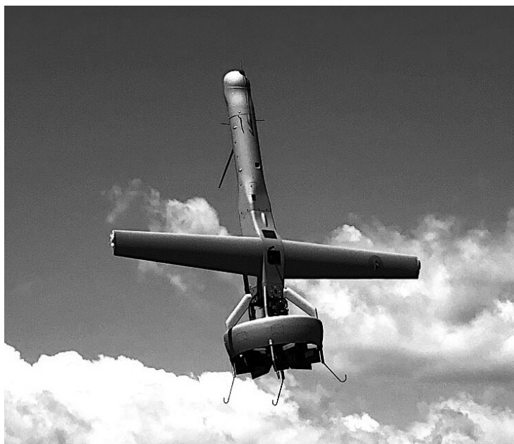
Рисунок 8 – Tail-sitter с винтокольцевым двигателем Martins UAV V-Bat [8]
