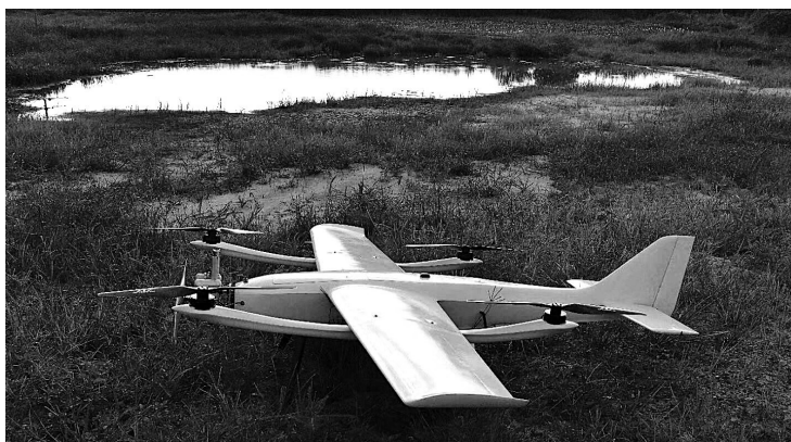
Рисунок 25 – Крылатый мультикоптер разработки Guangdong Guo-An Intelligent Aviation Technology Co., Ltd [26]
