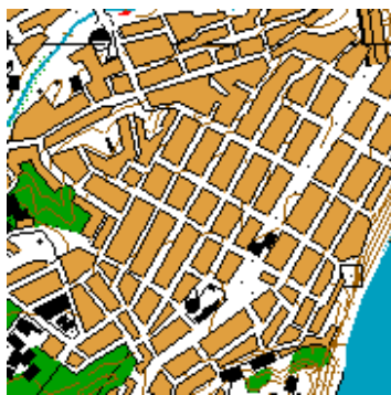
Рис. 159. План квартала крупного населенного пункта до (а) и после (б, в) генерализации: а – показаны кварталы крупного населенного пункта до выполнения формирования проездов; б – белым цветом отмечены расширенные проезды между кварталами; в – показаны кварталы после автоматической обрезки кварталов по расширенным проездам. В целом, мелкие кварталы объединены, ширина проездов увеличена
