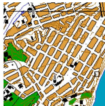
Рис. 159. План квартала крупного населенного пункта до (а) и после (б, в) генерализации: а – показаны кварталы крупного населенного пункта до выполнения формирования проездов; б – белым цветом отмечены расширенные проезды между кварталами; в – показаны кварталы после автоматической обрезки кварталов по расширенным проездам. В целом, мелкие кварталы объединены, ширина проездов увеличена
