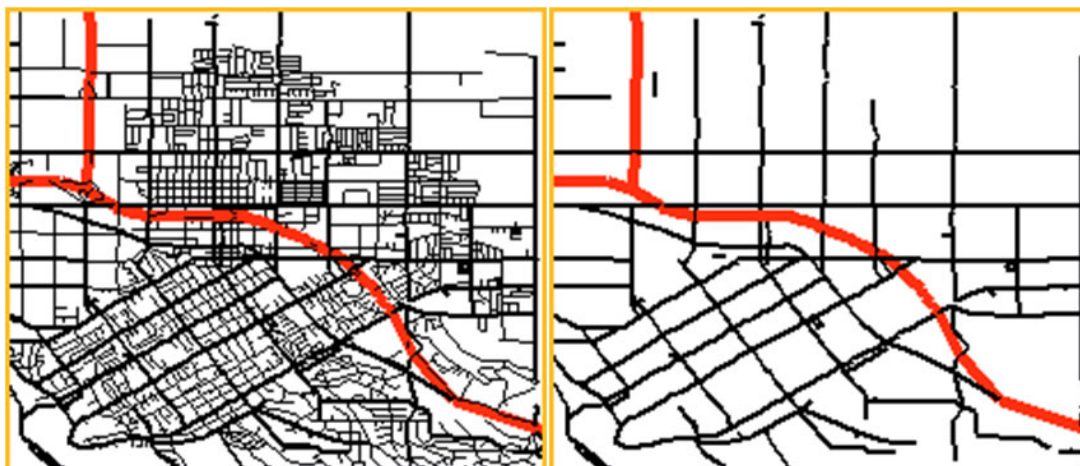
Рис. 168. Изображение квартала населенного пункта до и после генерализации Часть объектов изобразить условными значками (рис. 169).
