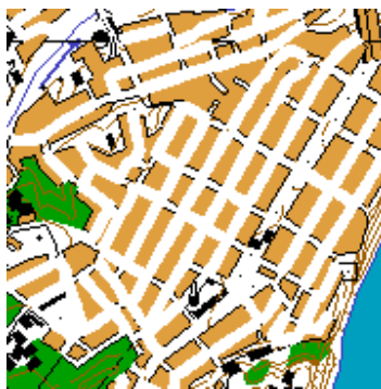
Рис. 159. План квартала крупного населенного пункта до (а) и после (б, в) генерализации: а – показаны кварталы крупного населенного пункта до выполнения формирования проездов; б – белым цветом отмечены расширенные проезды между кварталами; в – показаны кварталы после автоматической обрезки кварталов по расширенным проездам. В целом, мелкие кварталы объединены, ширина проездов увеличена
